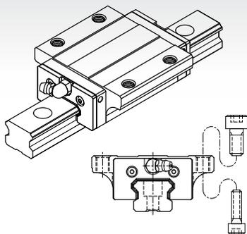
与MSB-E型具有相同断面尺寸，增加滑块的长度，并增加负荷钢珠数，提升整体的负荷能力。
